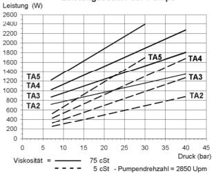
Die in den Kurven angegebenen Werte gelten für neue Pumpen (ohne Abnutzungserscheinungen).
