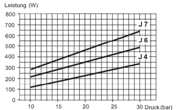
Viskosität = 5 cSt - Pumpendrehzahl = 2850 U/min
