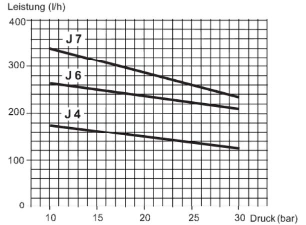
Viskosität = 5 cSt - Pumpendrehzahl = 2850 U/min
