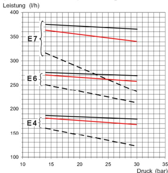
In den dargestellten Kurven ist bereits eine Abnutzung des Getriebes berücksichtigt. Achten Sie deshalb darauf, daß Sie bei der Wahl der Getriebekapazität, die Pumpe nicht überdimensionieren.
