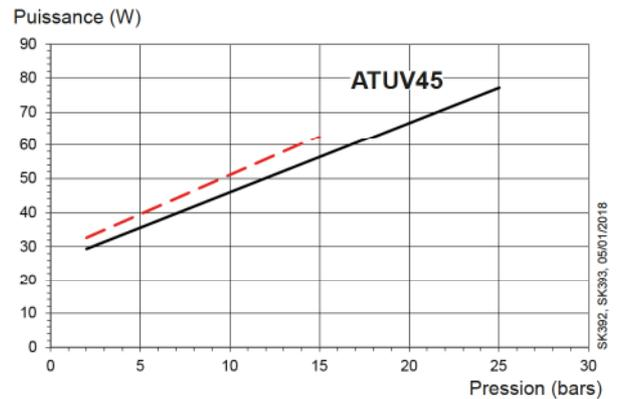
Viscosité = — 1,8 cSt — 5 cSt Vitesse de rotation = 2850 tr/min
