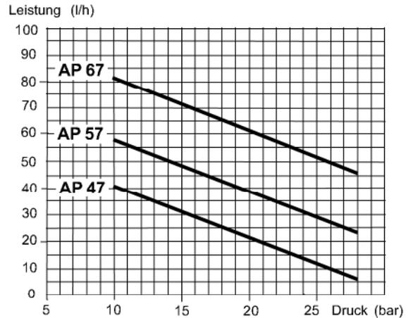
Viskosität = 5 cSt - Pumpendrehzahl = 2850 U/min
